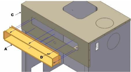
FIGURE 9A: HEAT DISCHARGE BOOT
